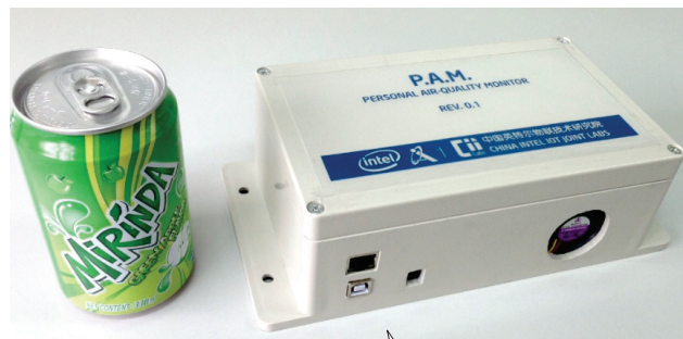
只有两个易拉罐大小的空气质量监测器 PAM
