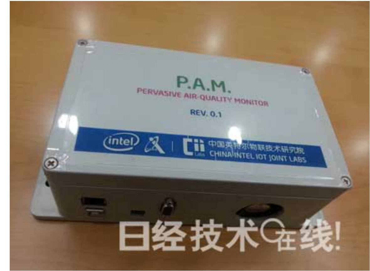
图3 姜小凡领导的研究团队正在开发的一种物美价廉的便携式个人空气质量监测仪（Pervasive Air-Quality Monitoring，PAM）
